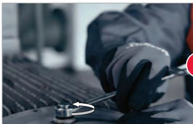
Limpe el punto de lubricación, retire la boquilla de lubricación
