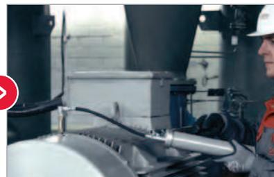
Prelubricar el punto de lubricación y los accesorios con el mismo lubricante y, dado el caso, prellenar la línea de manguera
