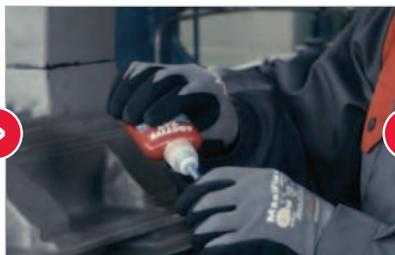
Aplique sellador de roscas (p. ej. Loctite® 243™) en todos los accesorios, enrosque el manguito de reducción
